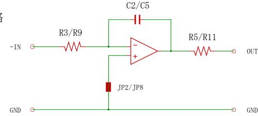
F : バランス／アンバランス変換回路
